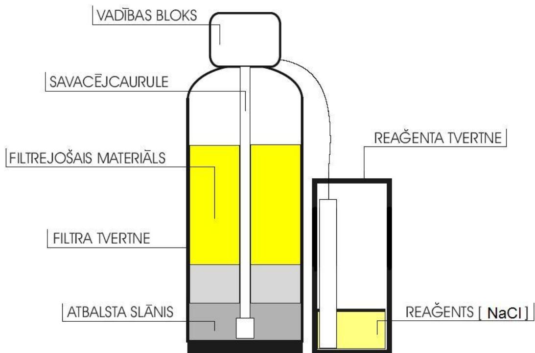
Ūdens attīrišanas iekārtai ir trīs galvenās pamatkomponentes: Filtrējošā materiāla tvertne, vadības bloks, un reaģenta tvertne. Duplex iekārta ir nokomplektēta ar divām paralēli strādājošām šādām iekārtām.
