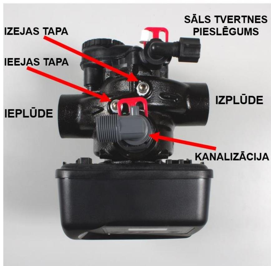
Ūdens attīrīšanas iekārtai aizmugurējās sānu daļā ir ūdensvada pieslēguma vietas. Katram pievienojumam ir norādīta ieplūde un izplūde ar bultiņām. Ja skatās uz iekārtu no priekšpuses, labajā pusē ir izplūde un kreisajā pusē – ieplūde. Iekārtai ūdensvada pievienojuma iekšējās vītnes izmērs ir 1.5” vai 2”(colla) gan ievadam, gan izvadam.
