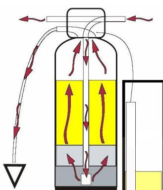
Pretplūsmas skalošanas režīmā mainās plūsmas virziens filtra tvertnē. Ūdens filtra tvertnē plūst no apakšas uz augšu un izvadīts uz kanalizāciju. Šis režīms ir nepieciešams, lai izskalotu no filtra uzkrātās vielas.
