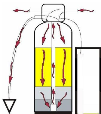
Skalošana pa plūsmai ir nepieciešama, lai izvadītu no filtra tvertnes lieko reāgentu uz kanalizāciju. Filtra tvertnē ūdens plūst no augšas uz apakšu un tad pa savācēju cauruli uz augšu un prom uz kanalizāciju. Plūsmas daudzumu regulē kanalizācijas pievienojuma līkumā ieliktā skalošana blīve (DLFC).
