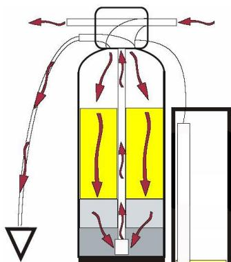
Skalošana pa plūsmai ir nepieciešama, lai izvadītu no filtra tvertnes lieko reaģēntu uz kanalizāciju. Filtra tvertnē ūdens plūst no augšas uz apakšu un tad pa savācēju cauruli uz augšu un prom uz kanalizāciju. Plūsmas daudzumu regulē kanalizācijas pievienojuma līkumā ieliktā skalošana blīve (DLFC).
