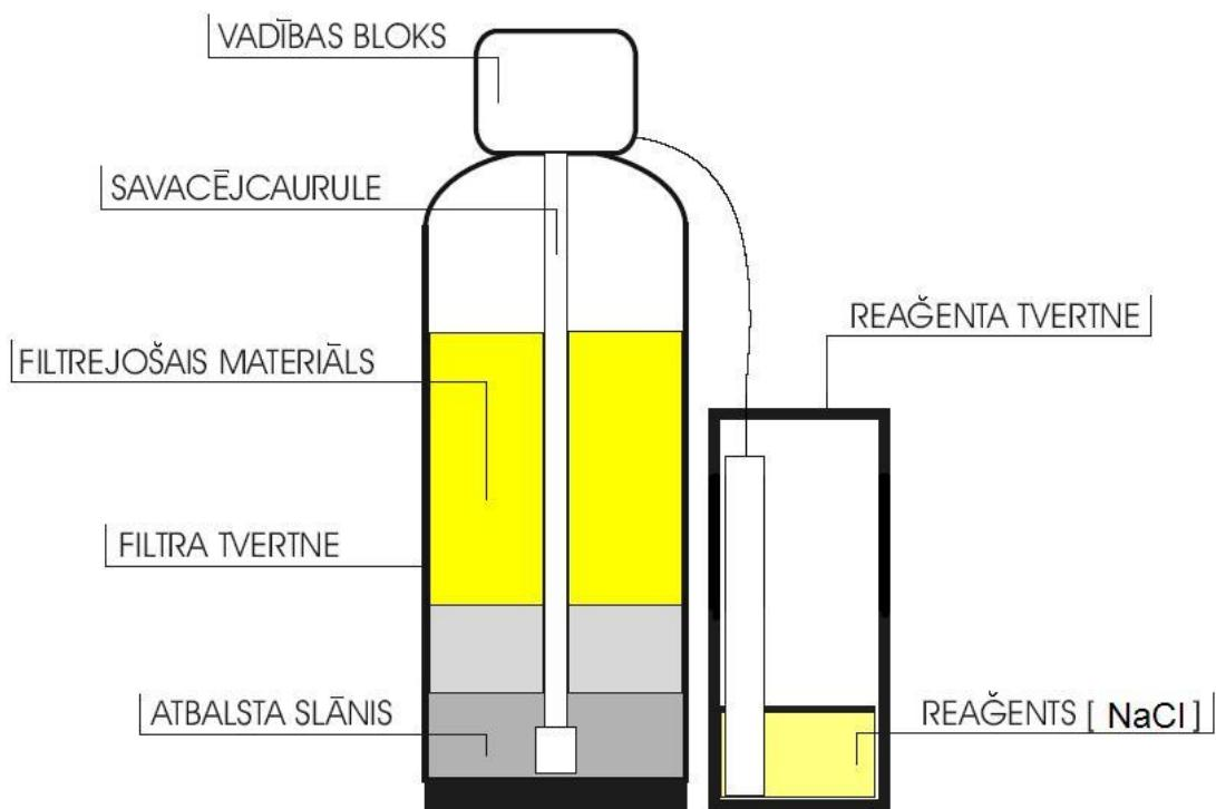
Ūdens attīrīšanas iekārtai ir trīs galvenās pamatkomponentes: Filtrējošā materiāla tvertne, vadības bloks, un reaģenta tvertne.
