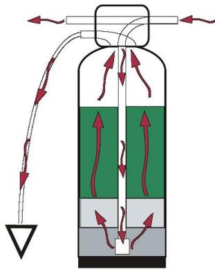
Pretplūsmas skalošanas režīmā mainās plūsmas virziens filtra tvertnē. Ūdens filtra tvertnē plūst no apakšas uz augšu un izvadīts uz kanalizāciju. Šis režīms ir nepieciešams, lai izskalotu no filtra uzkrātās vielas.
