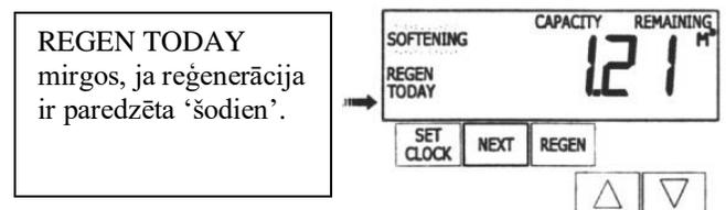
Lai uzsāktu manuālu reģenerāciju uzstādītajā atliktajā reģenerācijas laikā, nospiediet un palaidiet vaļā REGEN. Tad displejā mirgos vārds “REGEN TODAY”, norādot, ka sistēma uzsāks reģenerāciju iepriekš uzstādītajā reģenerācijas laikā. Ja esat nospiedis “REGEN” pogu kļūdas pēc, atkārtota pogas nospiešanas atcels pieprasījumu.
