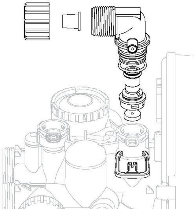
Iekārtai ir nepieciešams pieslēgums pie kanalizācijas, lai nodrošinātu regulāru iekārtas skalošanu. Skalošanas laikā no iekārtas tiek izvadīti uzkrātie netīrumi (duļķes, dzelzs, smiltis, māls utt.), kā arī reaģents ar kura palīdzību tiek atjaunota filtra materiāla spēja oksidēt dzelzi, mangānu un sērūdeņradi.
