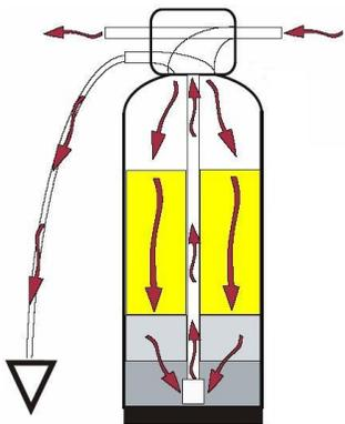
Skalošana pa plūsmai ir nepieciešama, lai izvadītu no filtra tvertnes atlikušās nogulsnes un sakārtotu filtrējošā materiāla slāņus pa vietām. Filtra tvertnē ūdens plūst no augšas uz apakšu un tad pa savācēju cauruli uz augšu un prom uz kanalizāciju. Plūsmas daudzumu regulē kanalizācijas pievienojuma līkumā ieliktā skalošana blīve (DLFC).
