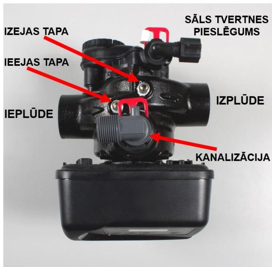
Ūdens attīrišanas iekārtai aizmugurējās sānu daļā ir ūdensvada pieslēguma vietas. Katram pievienojumam ir norādīta ieplūde un izplūde ar bultiņām. Ja skatās uz iekārtu no priekšpuses, labajā pusē ir izplūde un kreisajā pusē – ieplūde. Iekārtai ūdensvada pievienojuma iekšējās vītnes izmērs ir 1.5” vai 2”(colla) gan ievadam, gan izvadam.
